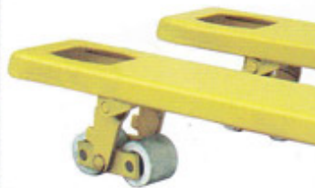
چرخ دوبله جلو (جفت چرخ) فشار روی واحد سطح را کاهش داده و برای حرکت از لبه سنگ های بارگیری و اتصال بتون و سطوح نامنوار مناسبتر می باشند.
