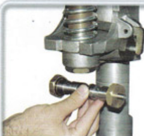
کلیه شیرهای هیدرولیکی در یک کارتریج قابل تعویض قرار گرفته و نیاز به نگهداری و تعمیر ندارد.
